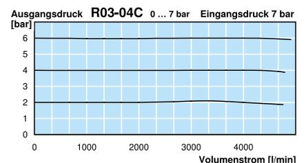
\*1 bei 7 bar Eingangsdruck und 6 bar Ausgangsdruck
