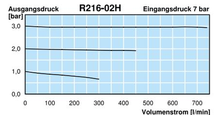
\*1 bei 7 bar Eingangsdruck und 3 bar Ausgangsdruck
