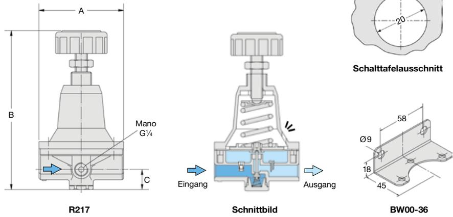
\*1 bei 8 bar Eingangsdruck, 6 bar Ausgangsdruck und 1 bar Druckabfall
